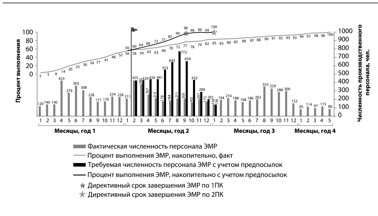
Рис. 6. Оценка ресурсов для завершения электромонтажных работ в Проекте 2
