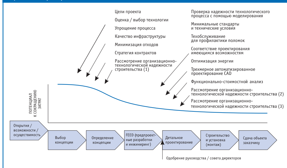
Рис. 4. Стандартная система предварительной проработки проекта (FEL)
