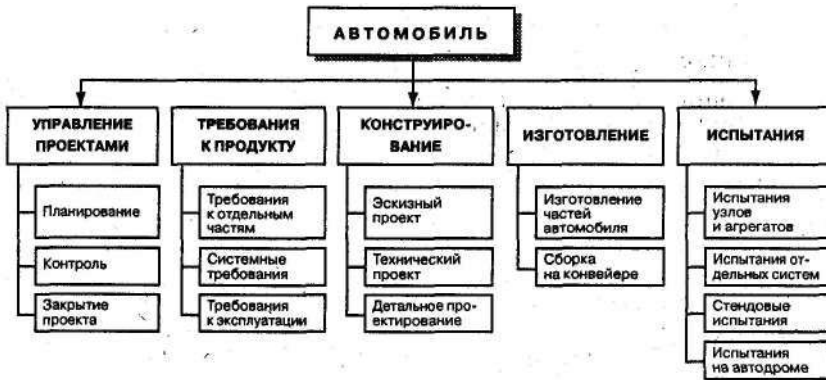
Рис. 2.5. Пример структурной декомпозиции проекта «Создание автомобиля», ориентированной на фазы жизненного цикла проекта
