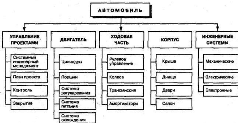
Рис. 2.4. Пример структурной декомпозиции проекта «Создание автомобиля», ориентированной на результаты проекта
