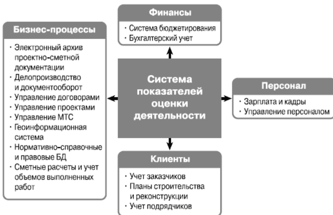
Рис. 3.9.1. Архитектура построения КИС компании «Газпромстройинжиниринг»
